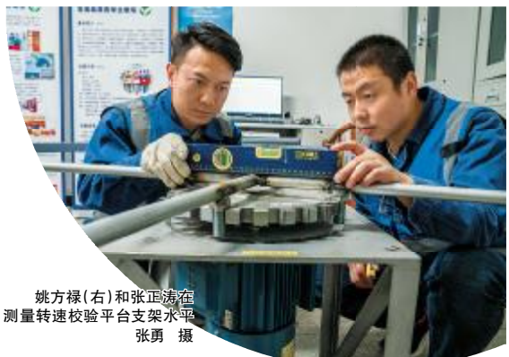
姚方禄(右)和张正涛在测量转速校验平台支架水平 张勇 摄
